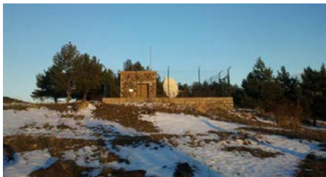
Figura 3.- Imatge de l'estació sísmica de Llívia (CLLI) cap al tard. Distingim la caseta que protegeix els dispositius electrònics i l'antena parabòlica de transmissió via satèl·lit. Aquesta estació també disposa d'un pilar geodèsic (darrere la casta) i forma part de la xarxa geodèsica de Catalunya.
