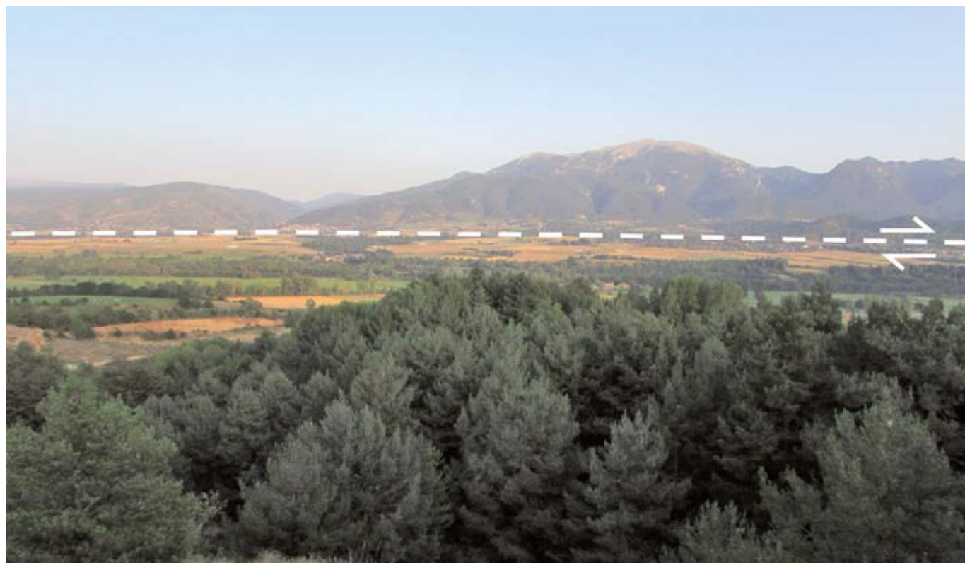
Figura 1. Aspecte del marge sud de la conca de la Cerdanya vist des del nord, prop d'All. El traçat aproximat de la falla de la Tet s'ha marcat en línia discontinua.
