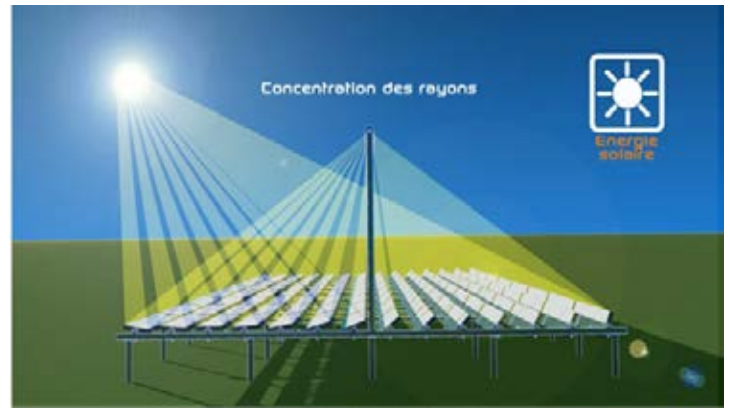
Principi de funcionament d'un sistema de Fresnel (eLLO).
